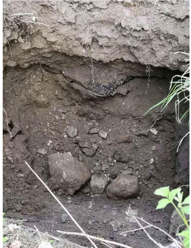
Kuva 16. Koekuoppa VAH15, jossa todettiin asfalttia.
